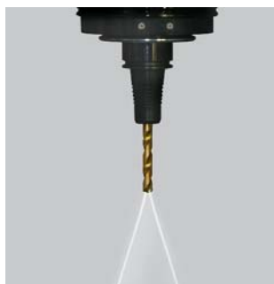
Подача воздуха и СОЖ через шпиндель
